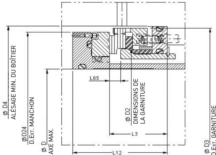
La garniture de confinement secondaire 8628VSC est disponible en tailles adaptées aux équipements connus des systèmes de pipeline. Formats adaptés aux pompes de pipeline les plus courantes avec axes jusqu'à 6 500 po.
